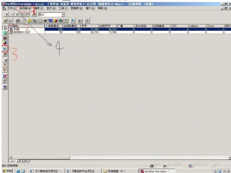
点击图中2处"本地",点击图中3处"捕捉"。这时连接运行星空极速连接网络,连接上网后可以看到图中4处,变为望远镜有个红点,这时候点击图中4处,这样就停止了捕捉
